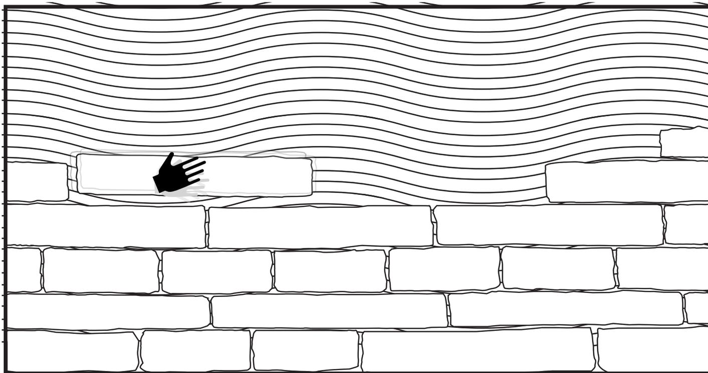
PRESIONAR LA PIEDRA Y MOVER DE UN LADO AL OTRO PARA UNA ÓPTIMA ADHERENCIA
