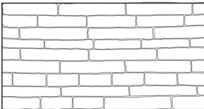
Como definición, nuestro producto corresponde a un enchape manufacturado tipo piedra, producto de la mezcla de cemento Portland, pigmentos minerales y agregados especiales, vaciados en moldes fabricados a partir de piedras naturales. Debido a que son materiales reconstituidos y elaborados en fábrica, presentan cierta fragilidad, variaciones de volumen y cambios de tono menores entre ellos.
